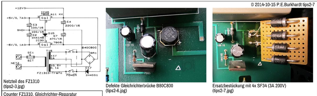
Die statische Prüfung des alten Gleichrichters ergab keinen Fehler. Alle 4 Einzeldioden zeigten normales Durchlass- und Sperrverhalten.
