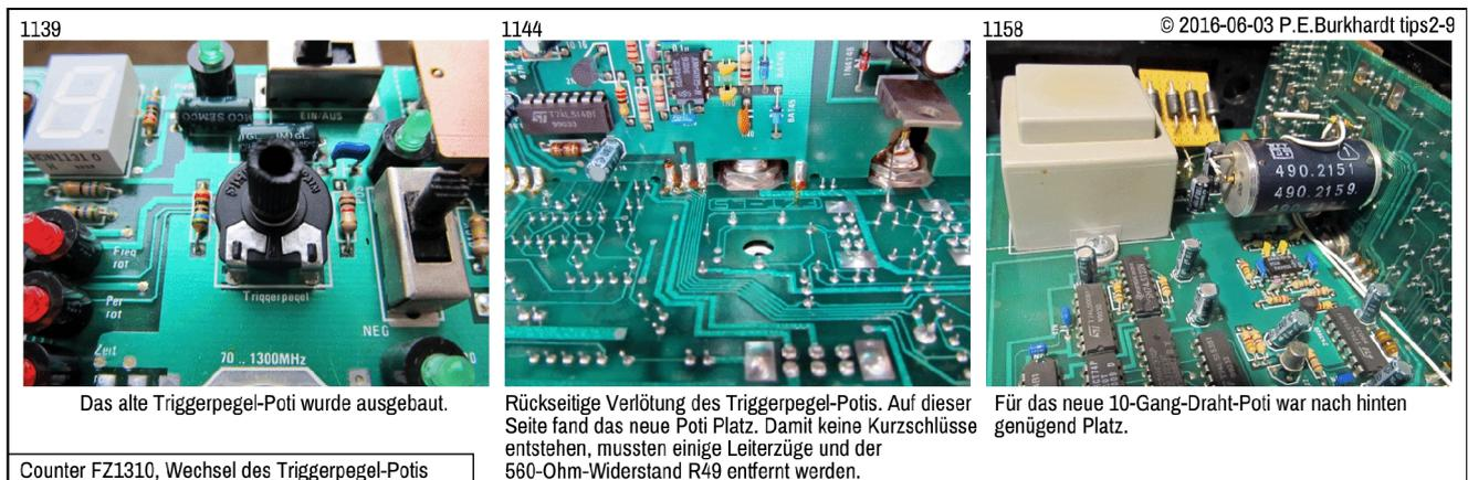
Das alte originale Triggerpegel-Poti ist von vorn auf die Leiterplatte gelötet und hat durch seine flache Bauform Platz zwischen Bedien-/Anzeigeplatine und der Abdeckplatte. Das neue Poti wurde (wie üblich) von hinten durch die Leiterplatte gesteckt und verschraubt. Deshalb war es nötig, die Aufnahme-Bohrung auf 12 mm zu erweitern.
