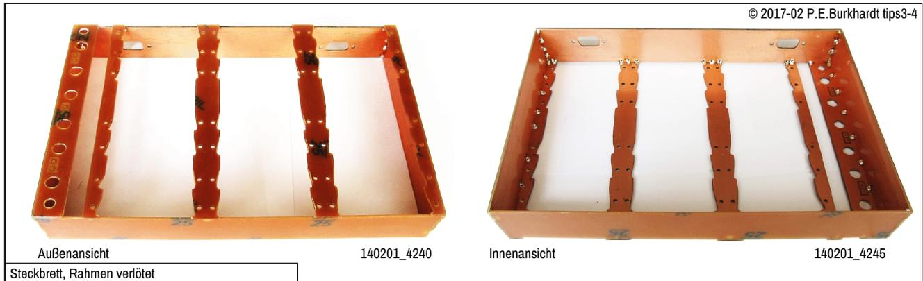
Das Löten selbst erfordert einen LötKolben mit ca. 40 W. Die Leistung einer Lötstation reicht dafür meist nicht aus. Allerdings darf der LötKolben auch nicht zu heiß sein, bzw. man sollte nur kurz an einem Punkt löten. Andernfalls kann es zum Ablösen der Cu-Schicht kommen, was sich dann durch hässliche helle Flecken bemerkbar macht, die von der Glasfaserseite aus zu sehen sind.
