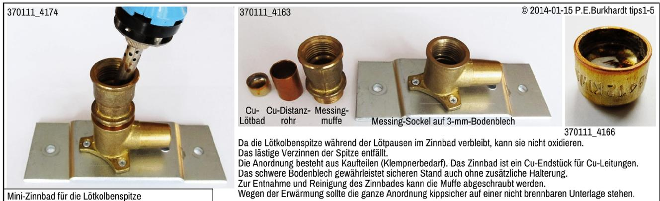
Alle Teile sind vom Baumarkt, das 3-mm-Bodenblech war gerade vorhanden. Das Cu-Distanzrohr wurde nur verwendet, da das Cu-Endstück nicht die gewünschte Größe hatte. In den Löt-pausen steckt die LötKolbenspitze ca. 5 mm im Zinnbad. Da kein Sauerstoff an die Spitze gelangt, kann sie auch nicht oxydieren.
