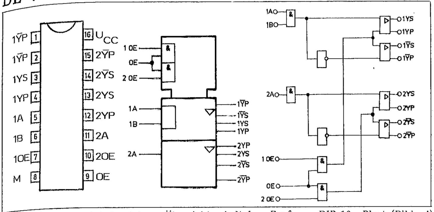
Anschlußbelegung, Schaltzeichen, Übersichtsschaltplan Bauform: DIP-16, Plast (Bild 4)
